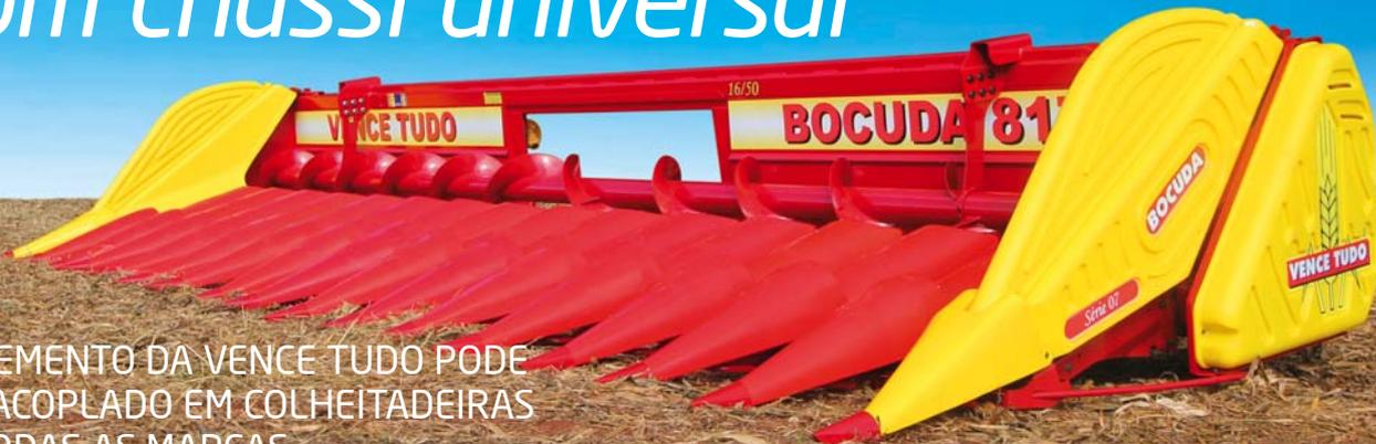
A Vence Tudo está apostando na versatilidade e facilidade de operação para manter as plataformas modelo Bocuda na liderança do segmento no mercado. A fabricante de implementos colocou no mercado a série 7, com maior área de limpeza, carenagem reformulada e sistema de remonte para facilitar a colheita de milho acamado. O acesso para lubrificação e troca de velocidade das linhas foi facilitado
